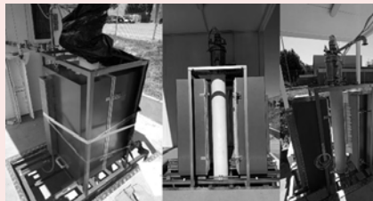
Reactor de pirólisis del metano
