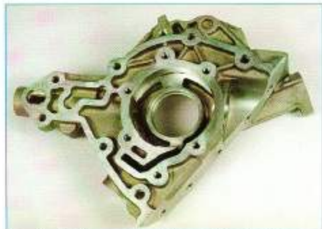
Transfer lineal para mecanizado de culatas (arriba), de Etxe-Tar; modelación a escala de modelos reales, en el Instituto de I+D del Centro Técnico de Nissan (derecha) y bomba de aceite Lotus mecanizada (sobre estas líneas).
