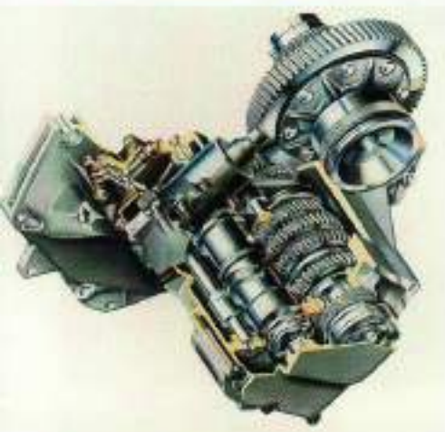
Banco de rodaje de bombas de inyección diesel (arriba), de Lucas Automotive, y caja de cambios secuencial (izquierda) desarrollada por Opel.
