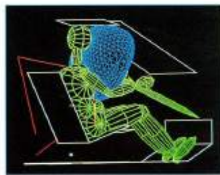
Esquema de funcionamiento de air-bag. En página 13, robot de montaje en una cadena española (arriba) y ejemplo de tendencia en vehículos familiares (abajo)
