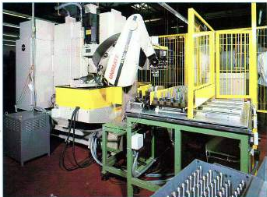
Robot de proceso de producción con brazo de carga y descarga (arriba); conjunto de instrumentación desarrollado por Ficosa (bajo estas líneas) y diversas piezas de seguridad para el automóvil desarrolladas por Fagor Ederlan.
