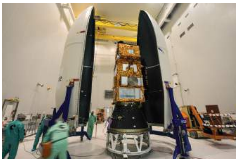
El Sentinel-2A es cargado en la cápsula del lanzador Vega que lo pondrá en órbita (Foto: ESA)
