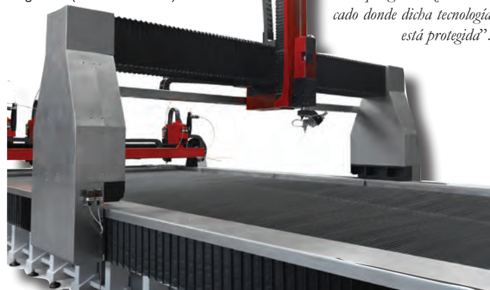
Instalación modular para corte de largas longitudes (sector ferroviario).
