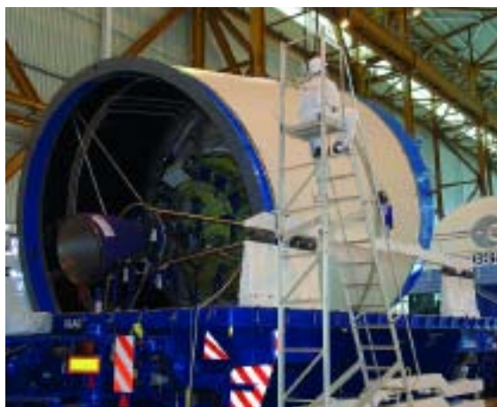
Fig. 54 Estructura en fibra de carbono de ARIANE 5 59
