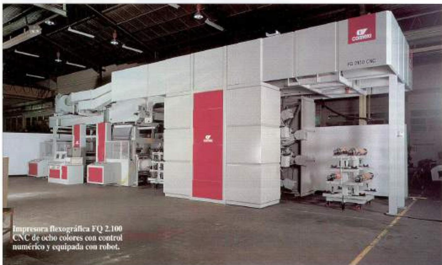
Impresora flexográfica FQ 2.100 CNC de ocho colores con control numérico y equipada con robot.
