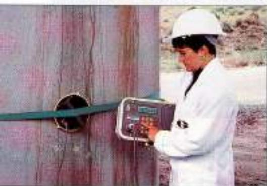
de hormigón aplicada mediante el corrosímetro Gecor-6, que permite controlar el confinamiento de la señal aplicada.
